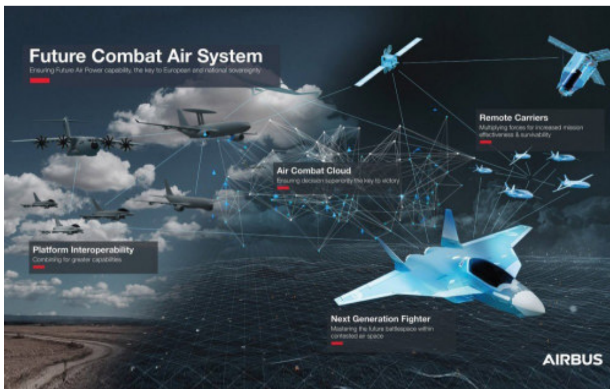
Figura 27. Concepto de nube de combate del FCAS [AIRBUS]
