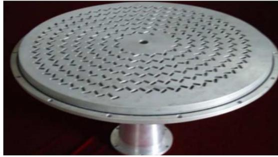
**Figura 2.23: Antena ranura de línea radial. Extraída de [14]**
