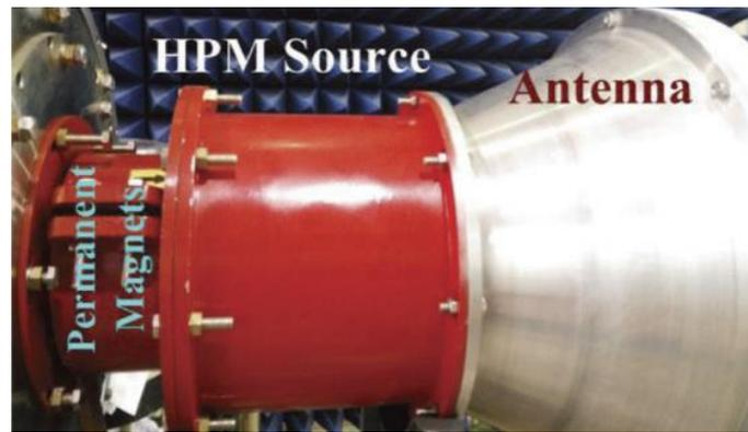
Figura 2.12: MDO con cátodo virtual y espejo magnético. Extraída de [10]
