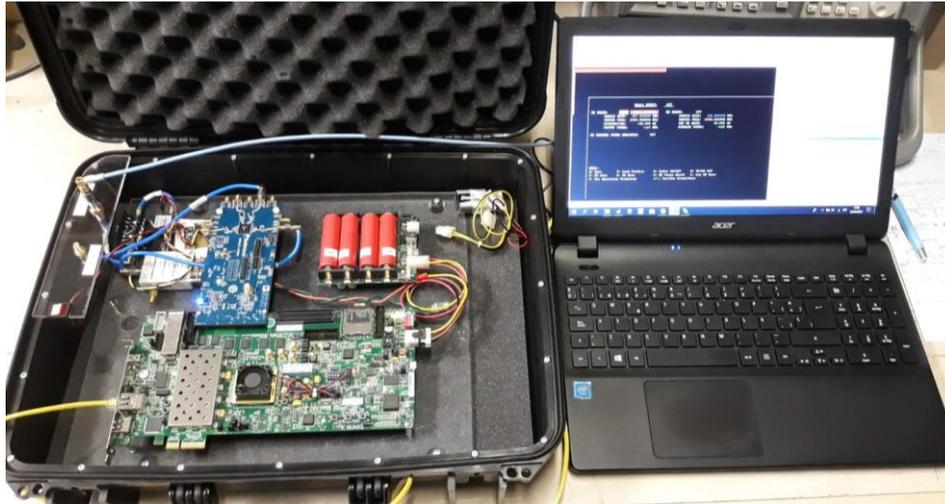
Figura 3.10: SDR junto con un ordenador que proporciona una interfaz
