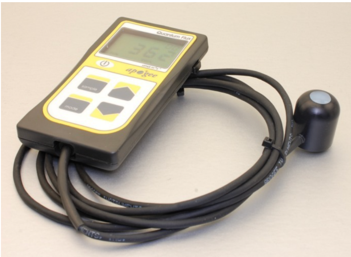
Fig. 2.8. Sensor Cuántico - Radiación sintéticamente Activa [25].
