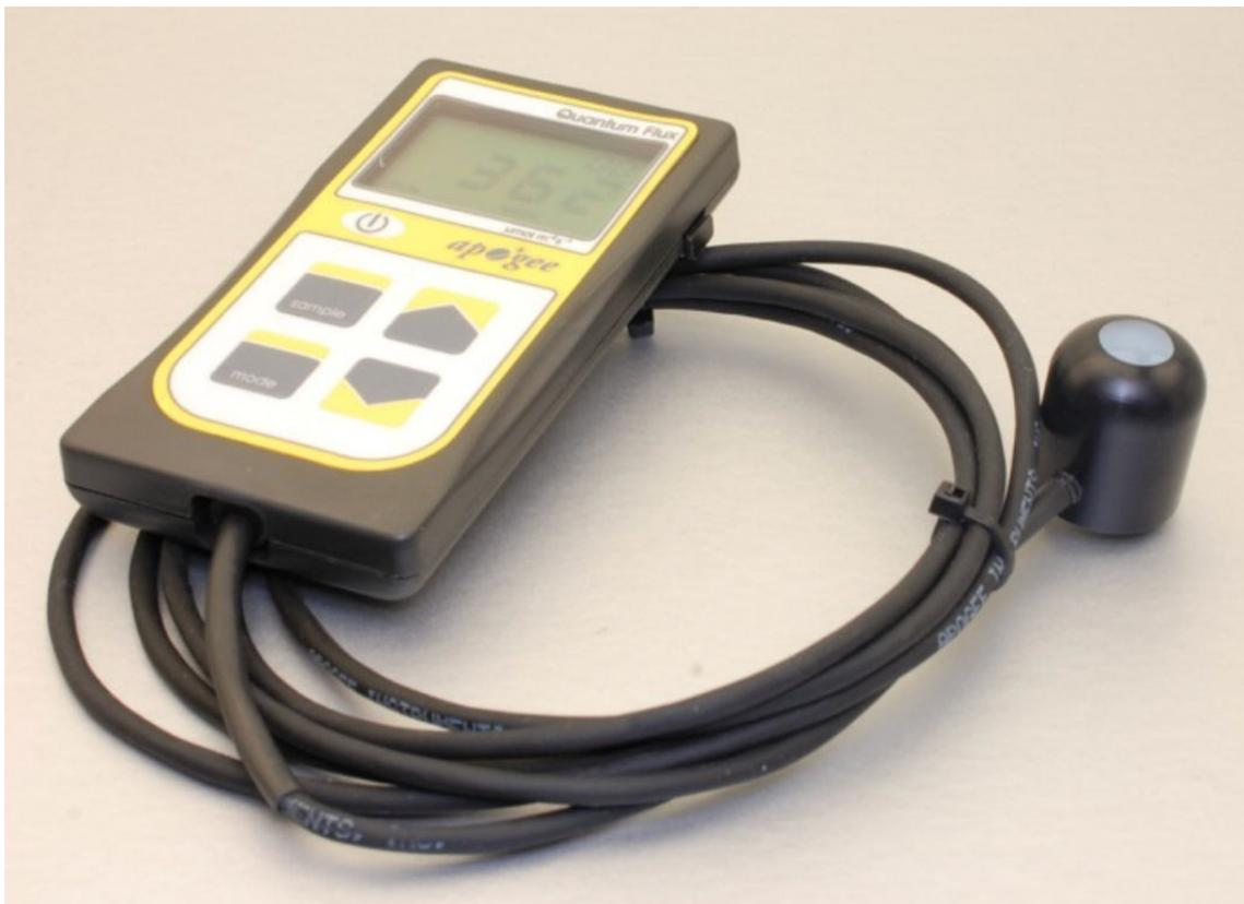
Fig. 2.8. Sensor Cuántico - Radiación sintéticamente Activa [25].
