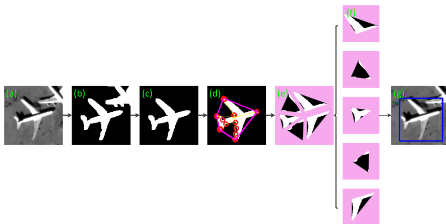
BOSQUEJO ESQUEMÁTICO DEL PROCESO DE DETECCIÓN DE OBJETOS PARA UN EJEMPLO DE AVIÓN. EN LA FIGURA, (A) IMAGEN DE ENTRADA, (B) BINARIZACIÓN, (C) LAS REGIONES CONECTADAS EXTRAÍDAS, (D) DETERMINACIÓN DEL RECORRIDO CONVEXO DE ESQUINA, (E) EFECTO DE SEGMENTACIÓN, (F) MUESTRA CADA FRAGMENTO, Y (G) DA LOS RESULTADOS FINALES. [31]
