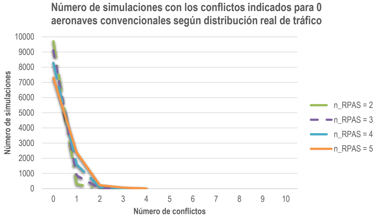
Ilustración 29. Número de simulaciones con el número de conflictos indicados para la configuración de 0 aeronaves convencionales reales con distintos valores de RPAS.
