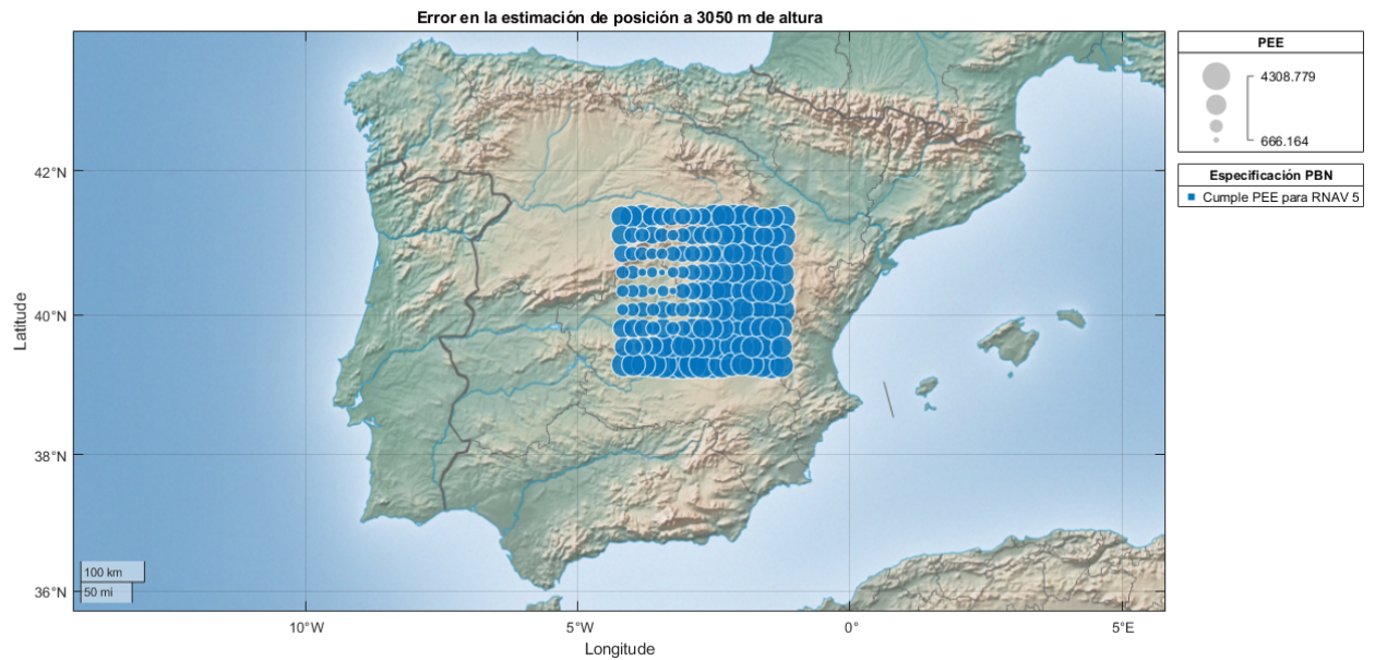
Figura 47. Evaluación del PEE DME/DME en 153 puntos sobre la región central de la península para verificar si se podrían cumplir especificaciones RNAV 5. Error de cada DME caracterizado según (35). Todos los valores expresados en metros.
