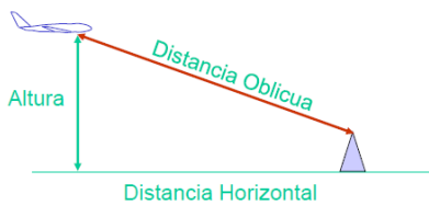
Figura 17. Mediante la diferencia del tiempo entre el envío y la recepción de la señal, es posible determinar la distancia oblicua que separa vehículo y estación. Obtenido de [31].
